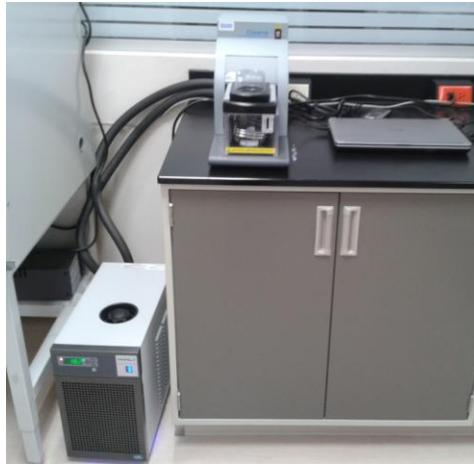
1. Con el equipo apagado sacar el contenedor para agua y llenarlo hasta donde indique el método, en el caso de ADN es hasta el nivel 12 o 15 (recomendado).
