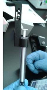
5. Girar la tapa de la plataforma negra (**chip priming station**) y colocar en su lugar la jeringa con cuidado de no trasroscarla ni forzarla, solo girar hasta que tope; ajustar al tamaño del chip y revisar que el empaque este bien colocado y el seguro ajustado a la derecha.
