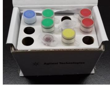
2. Colocar 550  $\mu\text{L}$  (matriz para el gel) del tubo de tapa roja en una columna con filtro, colocar centrifugar la columna 10 minutos a 14000 rpm a 10°C, transferir 65  $\mu\text{L}$  de esta matriz a un tubo de 200  $\mu\text{L}$ , esta matriz es incolora y solo es estable 1 mes después de ese periodo no se debe utilizar.
