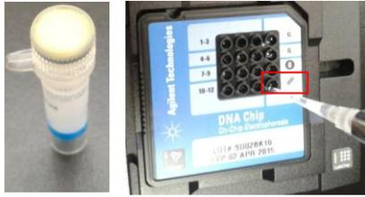
14. Colocar el chip en el agitador a 2400rpm 1 minuto o en el vortex de chips IKA MS 3 Vortexer 1 minuto a 2400 (máximo), el agitador ya está programado para solo agitar durante un minuto.
